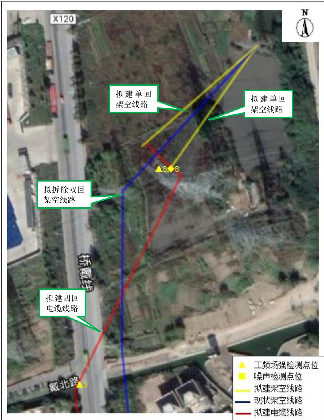
图 4-2：戴永 1633 线（永兴 1634 线）5#-12#迁移改造部分线路路径及检测点位示意图（a）
