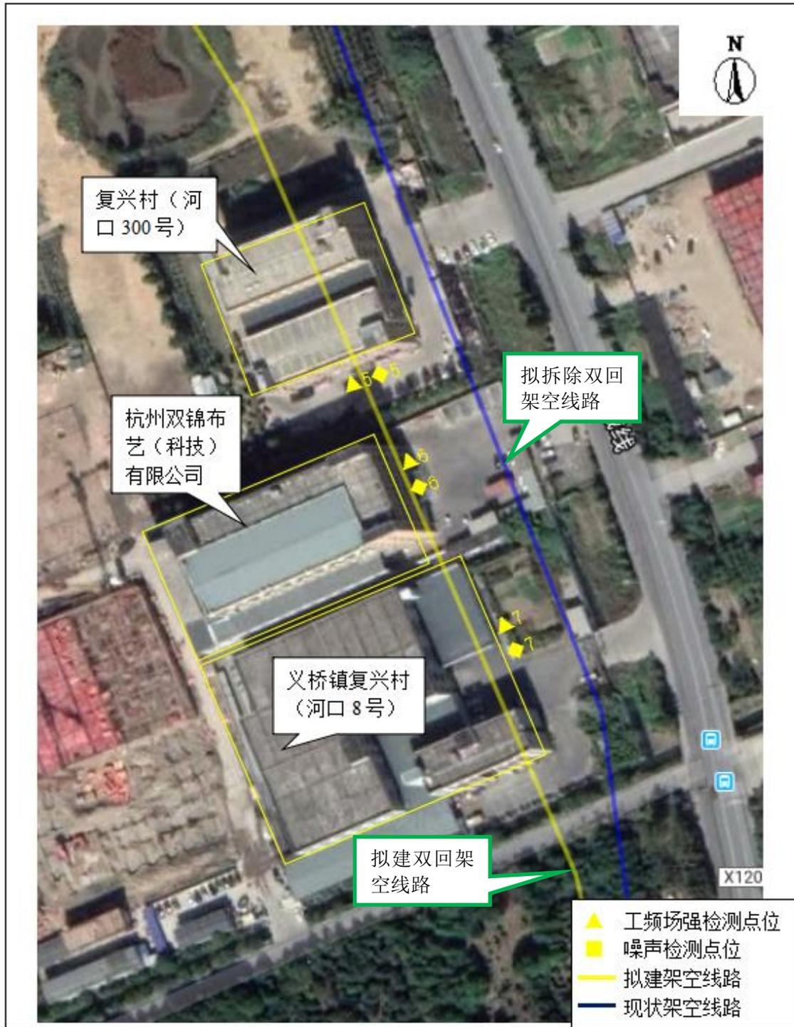
图 4-1：戴许 1635 线（许贤 1636 线）5#-10#迁移改造部分线路路径及检测点位示意图（c）
