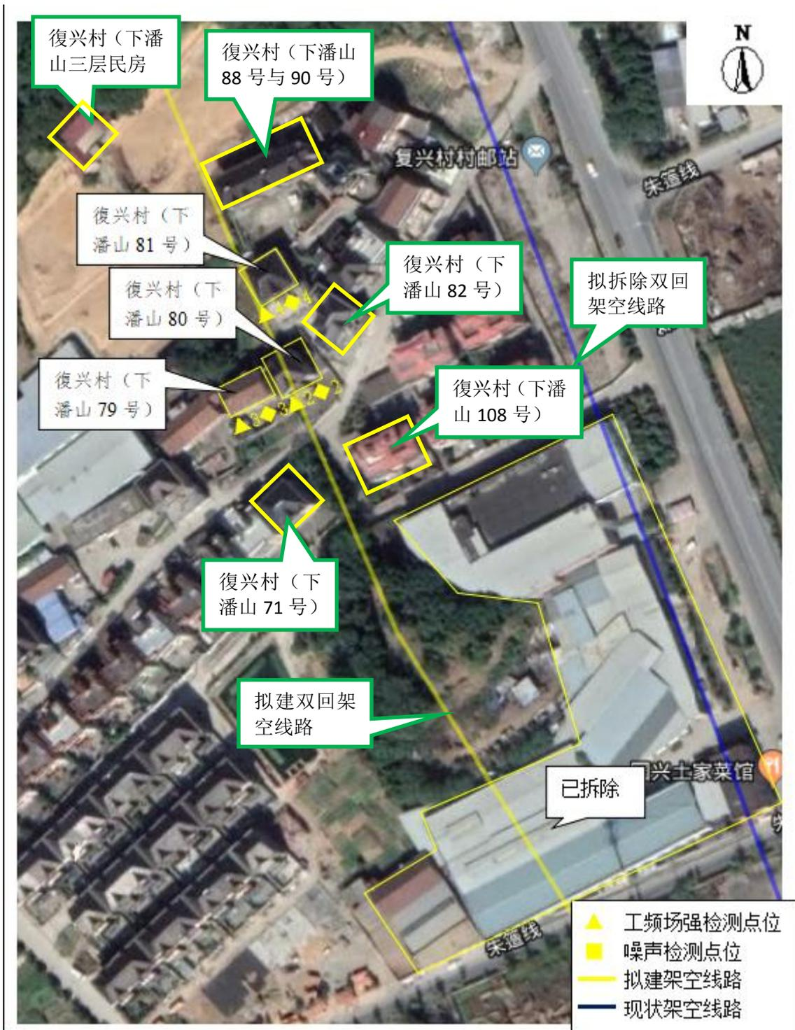
图 4-1: 戴许 1635 线 (许贤 1636 线) 5#-10# 迁移改造部分线路路径及检测点位示意图 (b)
